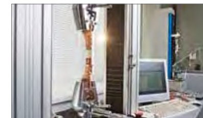
Испытания наконечников на разрывное усилие
