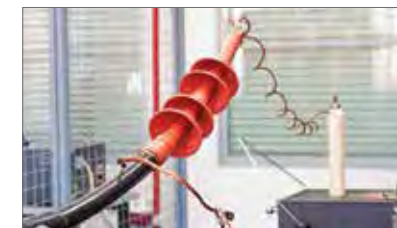
Высоковольтные испытания кабельных муфт
