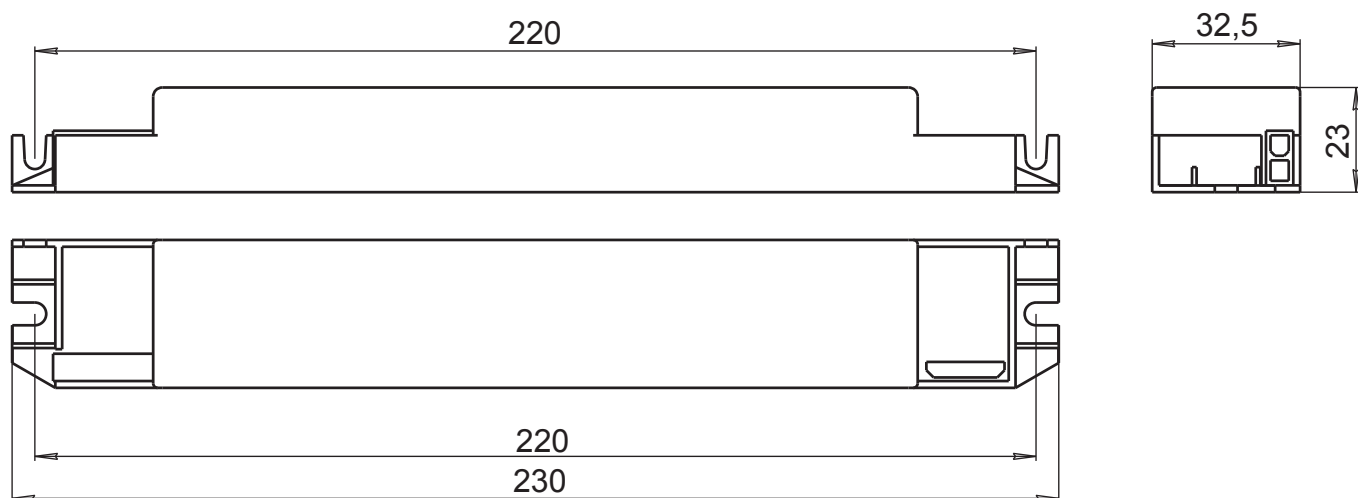
Блоки аварийного питания BS-STABILAR2-B3/B4-LED
